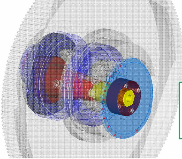
La máquina se compone por un juego de doble excéntrico cuya posición angular, se fija por el apriete de un cono.
